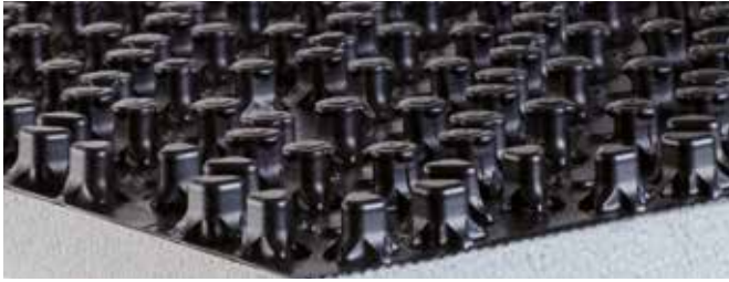
Der Noppenplatte dient zur Aufnahme der Heizrohre und zum kontrollierten Schwundabbau des Estrichs.
