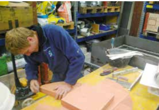
... Zuschneiden der Platten für einen Pizza-Ofen ...
