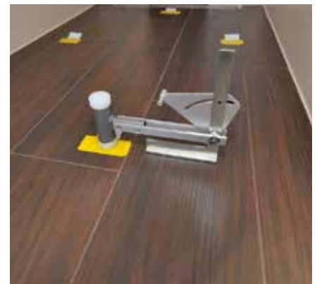
Die Geräuscherzeugung zur Simulation haustechnischer Benutzungsgeräusche erfolgt mit dem Pendelfallhammer.
